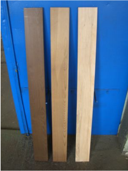
Bild 30: Thermoholz der Rotbuche ( Fagus sylvatica ) im Vergleich (von rechts nach links): gedämpft (Rotkern), TMT-Buche 190 (thermobehandelt bis ca. 190 °C), TMT-Buche 200 (thermobehandelt bis ca. 200 °C) (Foto: Michel Weidner) [27]
