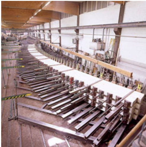
Bild 25: gekrümmter BSH Träger bei der Herstellung (links), fertiges BSH mit verschiedenen Querschnitten (rechts)
